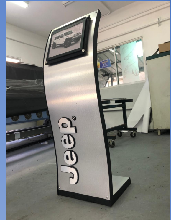
FABRICACION DE TOTEM EN ACM Y ESTRUCTURA DE HIERRO
